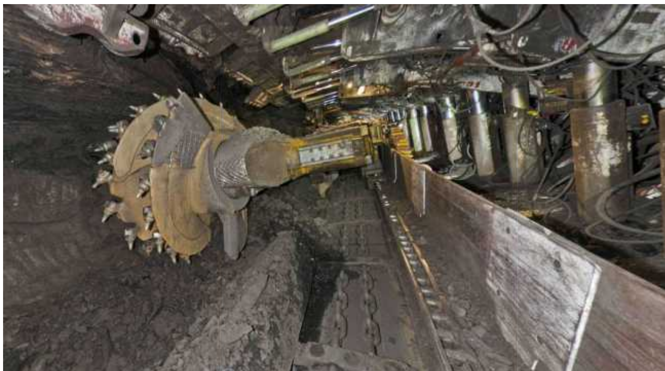
Слика 1: Основен изглед на производствената опрема (комбајн) и хидраулична подграда на работното чело
